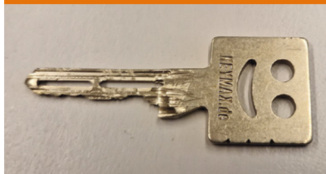
Durch Täter bearbeiteter Schlüsselrohling
